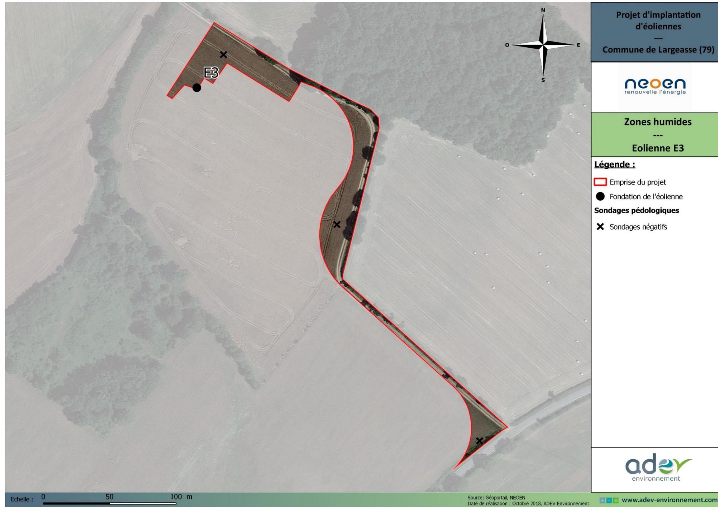
Figure 14 : Localisation des sondages pédologiques sur l'emprise de projet de l'éolienne E3
